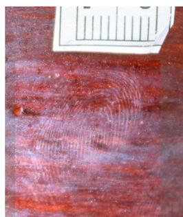
Figura 1. Fragmento revelado em madeira envernizada, utilizando pó magnético (*silver/black*).
