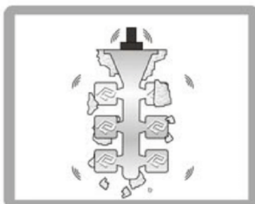
08 - Remoção da casca cerâmica Ceramic shell removal Remoción de la cáscara cerámica Entfernen der keramischen Schale
