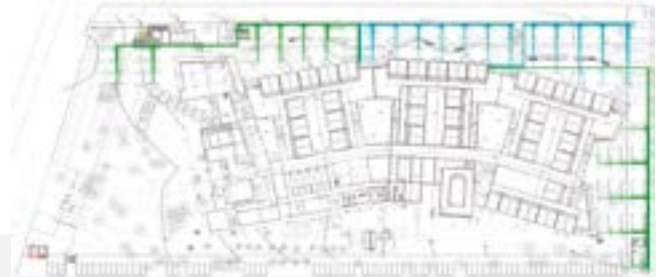
Planta distribución pozos geotermia
