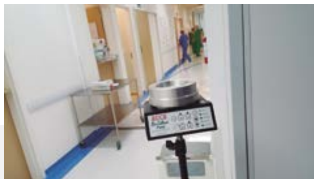
Figura 4: CC – Hospital “C”, medição ao lado do tapume da obra.
