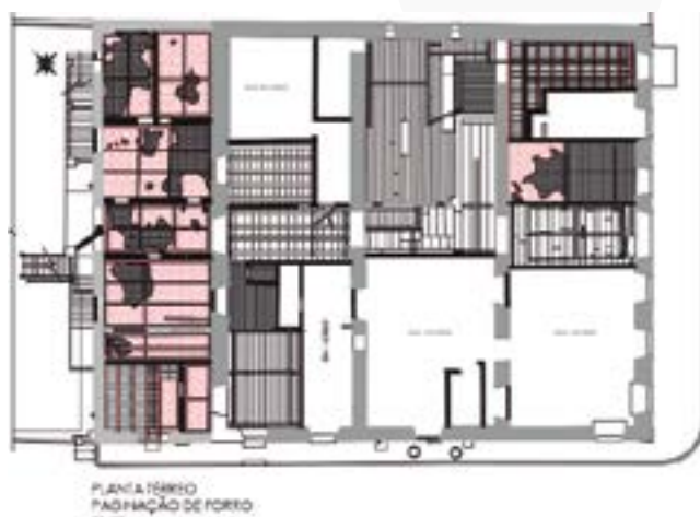
Figura 4: Planta de paginação do forro do térreo
